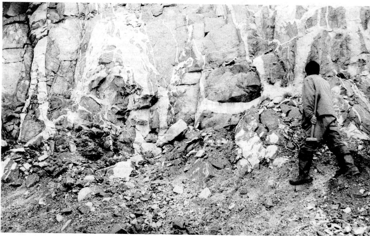
Рис. 2. Жильный плагиоплитовый штокверк в рудных пироксенитах (Западный карьер Качканарского ГОКа).
