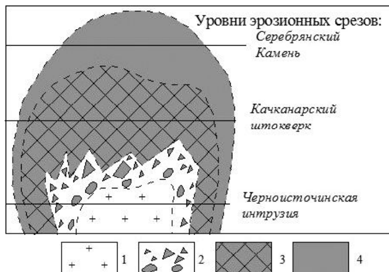
Рис. 3. Обобщенная схема строения разреза ПП-серии и связанного с ней контактово-метаморфического ореола в Платиноносном поясе Урала по интерпретации автора.
