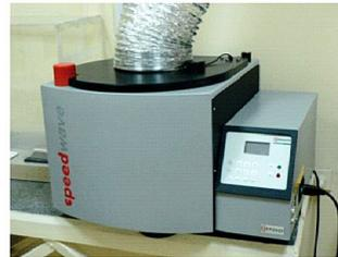
Система микроволнового вскрытия MWS-3
