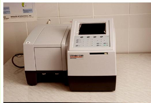
Оптический спектрометр UV1240
