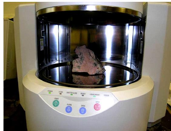
Камера спектрометра EDX-900HS с образцом
