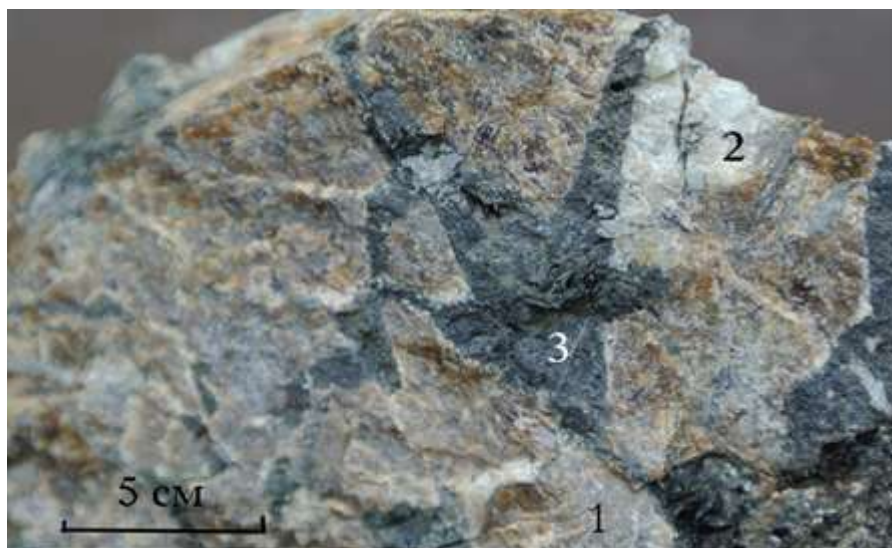
Рисунок 7.3 - Развитие ксенотима (1) с апатитом (2) по новообразованному иттроэпидоту (3) по карбонатитам в карьере по отработке жилы № 175
