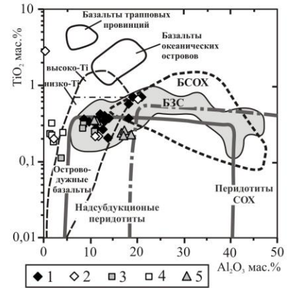
Рисунок 2 – Диаграмма Al_2O_3 - TiO_2 для хромовых шпинелей из параллельных даек (1-4) и подушечных лав (5) офиолитов в восточном обрамлении Ревдинского массива (Берзин, 2013) с полями составов для хромовой шпинели из вулканитов различных геодинамических обстановок по (Kamenetsky et al., 2001). 1-2, 5 – г. Азов, 3-4 – затопленный карьер; 1, 3 – центр зерен, 2, 4 – края зерен
