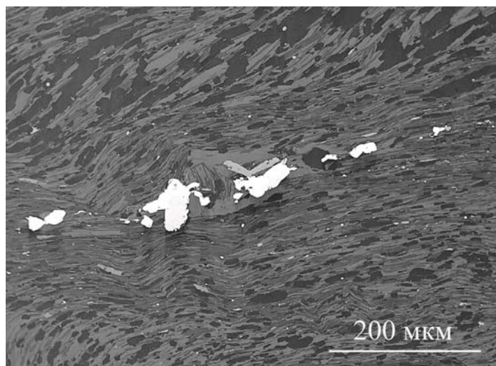
Рис. 5. Цепочка индивидов пирита (белое) в кварц-хлорит-серицитовом сланце. Скважина Лензитская № 77, глубина 3509 м. BSE-изображение, CAMECA SX 100.
