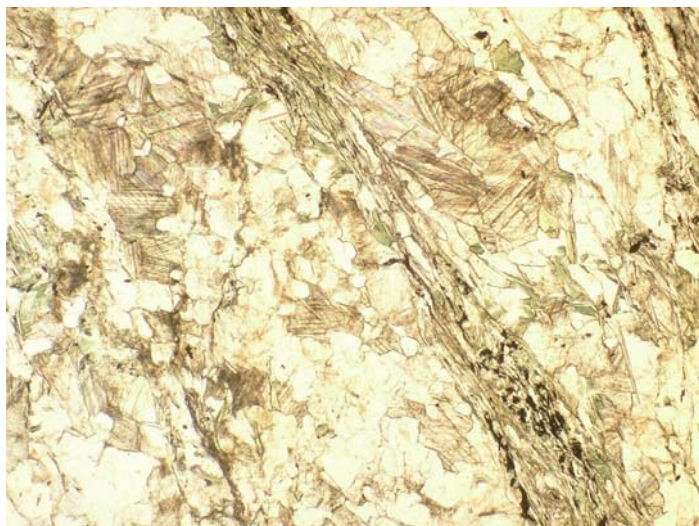
Рис. 3. Кварц-хлорит-серицит-карбонатная порода. Скважина Лензитская № 77, глубина 3516 м. Проходящий свет. Размер поля зрения 3 мм.
