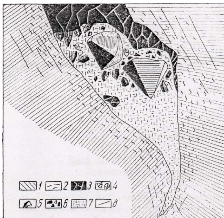
Рис. 5. Светлинское месторождение. Поперечный вертикальный разрез уникальной хрусталеносной полости. Условные обозначения: 1 – кристаллические сланцы; 2 – гидротермально измененные породы; 3 – жильный кварц молочно-белый, гигантозернистый, массивный; 4 – жильный кварц стекловидный, шестоватый; 5 – кристаллы горного хрусталя; 6 – обломки жильного кварца; 7 – глинисто-слюдистый материал гнездового выполнения; 8 – трещины.
