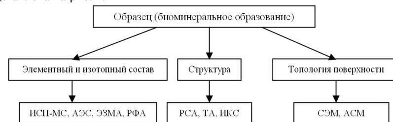
Рис 1. Схема исследования состава и структуры биоминеральных образований с помощью комплекса методов: масс-спектрометрии с индуктивно связанной плазмой (ИСП-МС), атомно-эмиссионной спектрометрии (АЭС), электронно-зондового микроанализа (ЭЗМА), рентгенофлуоресцентного анализа (РФА), рентгеноструктурного анализа (РСА), термического анализа (ТА), инфракрасной спектроскопии (ИКС), сканирующей электронной микроскопии (СЭМ), атомно-силовой микроскопии (АСМ).
