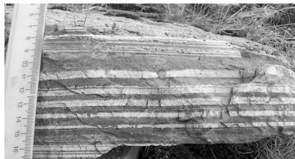
Рис. 4. Тонкое чередование песчаников (алевролитов) и глинистых кремней, слагающих переходную толщу между песчаниками двух типов (левобережье р. Икстимер).
