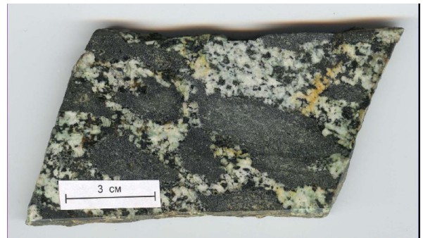
Рис. 2. Преобладающая картина: индивидуализированные, с довольно резкими контурами мелкозернистые блоки в диоритоподобном цементе.
