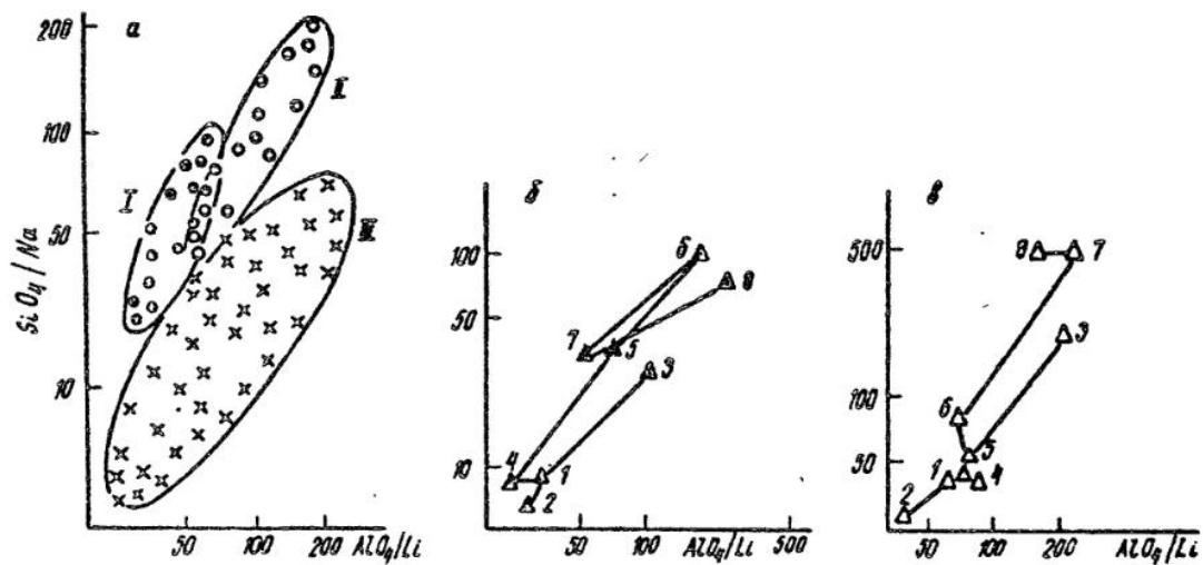
Соотношение яркостей свечения  $\text{SiO}_4^{\text{def}}$  и  $\text{AlO}_4/\text{Li}$  в кварцах различных генетических типов (а), в кварце Карайновского (б) и Светлореченского (в) месторождений.
