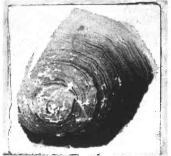
Фиг.3а Продольный полированный срез близкий к оси строматолита. Видно чередование слоев с разной текстурой. Слева широкая зона плотного, с металлическим блеском боксита. х 2.
