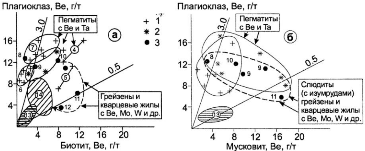
Рис. 2. Распределение бериллия между плагиоклазом и биотитом (а), и между плагиоклазом и мусковитом (б) из фтороносных гранитоидов Урала.
