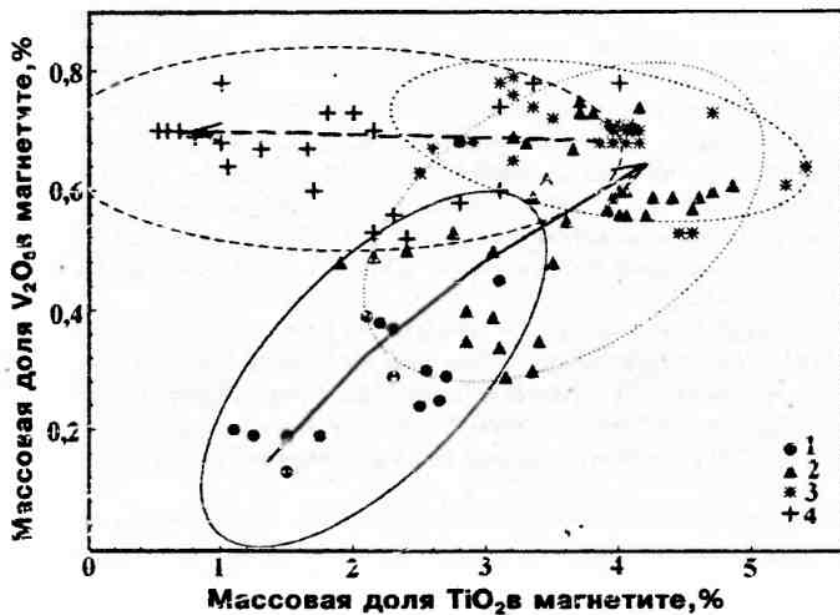
Рис.2. Характер изменения соотношений титана и ванадия в рудных магнетитах на различных этапах их формирования (по данным В.Г.Фоминых).
