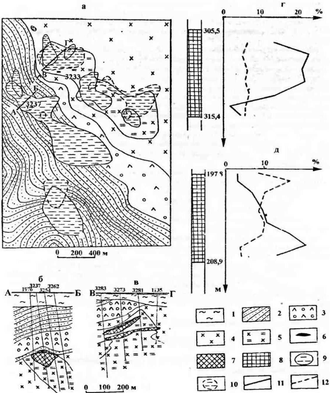
Геологический план горизонта 250 м (а) и геологические разрезы через Западную (б) и Восточную (в) залежи с графиками содержаний металлов в массивных рудах по скважинам 3237 (г) и 3233 (д).
