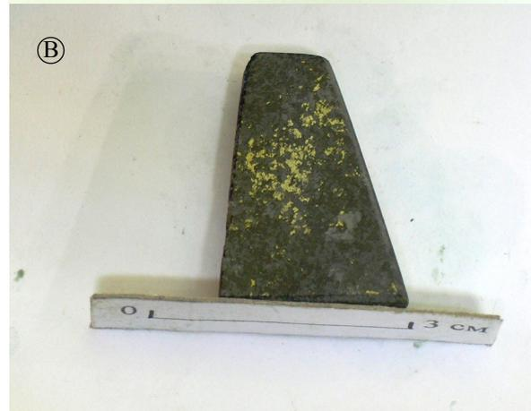
Рис. 4 (А, Б, В). Минерализованные габбро-долериты серые с редковкрапленной и прожилково-вкрапленной медносульфидной минерализацией (обр. 226В99, 1В99).
