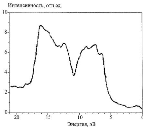
Рис.3. Рентгеновский фотоэлектронный спектр O2p-полосы валентной зоны кварца [Barr, 1991].
