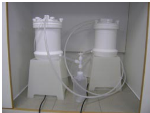
Рис. 2. Установка для очистки кислот методом недокипящей дистилляции (Berghoff).
