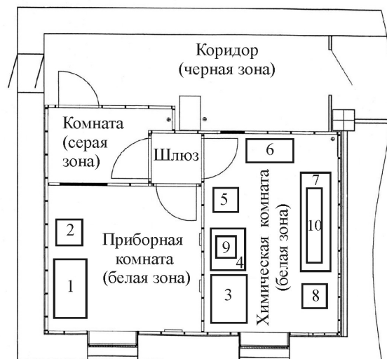
Рис. 1. Схема КЧП. 1 – Масс-спектрометр ELAN 9000 (PerkinElmer); 2 – Приставка для лазерной абляции LSX-500 (Cetac); 3 – Вытяжной шкаф с одной вытяжкой; 4 – Вытяжной шкаф с одной вытяжкой; 5 – Вытяжной шкаф для кислот; 6 – Печь муфельная СНОЛ; 7 – Вытяжной шкаф с двумя вытяжками; 8 – Электронные весы (AND, Shimadzu); 9 – Микроволновая печь Гефест; 10 – Система очистки воды Millipore.
