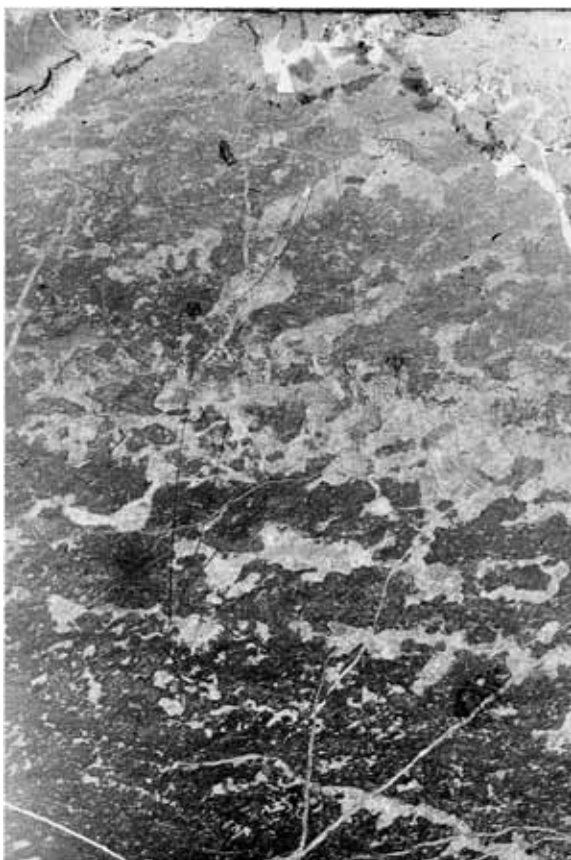
Рис. 1. Узорчатый известняк ( \times 3 ) в верхнефаменских известняках; левый берег р. Реж выше с. Сохарево. Наиболее четко узорчатая структура видна в средней части шлифа.
