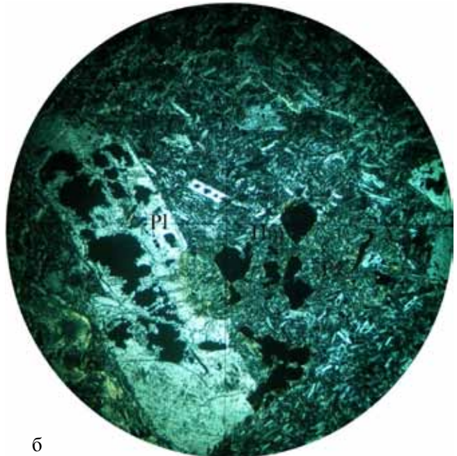
Рис. 3. Трахиандезибазальт (обр. 5752-1) при естественном (а) и поляризованном (б) свете. Диаметр поля зрения 2.7 мм. Слева виден вкрапленник плаггиоклаза (Pl), в центральной части – зерно хлоритизированного пироксена (Px) и выделения гематита (Hm).
