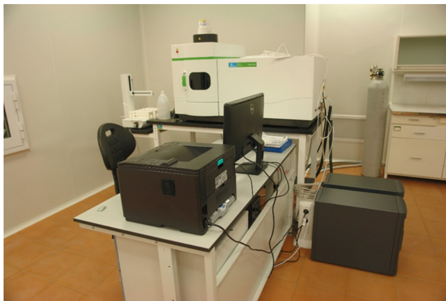
Рис. 1. ИСП-АЭС-спектрометр Optima 8000 в блоке чистых помещений ИГГ УрО РАН.
