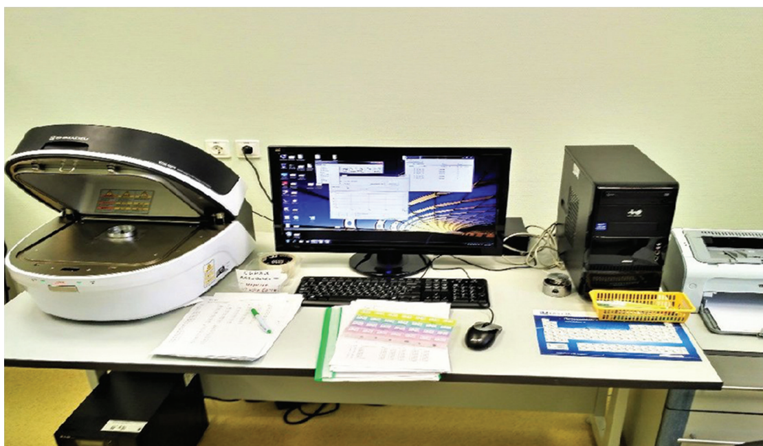
Рис. 1. Общий вид спектрометра EDX-8000 фирмы Shimadzu (Япония).
