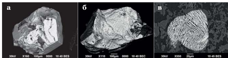
Изображения в отраженных электронах кристаллов платины и хромита (а, б) и зерна циркона (в)
