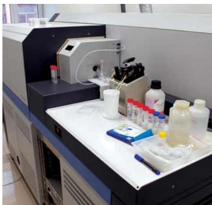
Мультиколлекторный масс-спектрометр с индуктивно связанной плазмой Neptune Plus: определение изотопов Li, B, Mg, Si, Ca, Cr, Fe, Zn, Sr, Mo, Ag, Cd, Sn, Nd, Hf, W, Os, Hg, Pb, Th, U в растворах с точностью определения до единиц ppm
