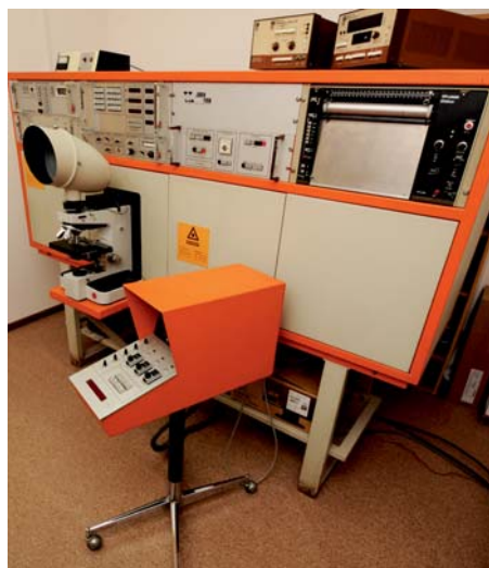
Рамановский лазерный микрозонд «Mole» и типичные спектры трех цирконов с разной степенью радиационного повреждения структуры
