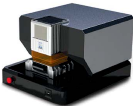
Приставка для лазерной абляции проб NWR213 с YAG:Nd-лазером (излучение 213 нм, диаметр кратера 4-250 мкм): высокоточное определение следовых содержаний элементов, плоская форма кратера, анализ прозрачных и непрозрачных минералов, металлов и др., высокая эффективность испарения и отбора материала проб
