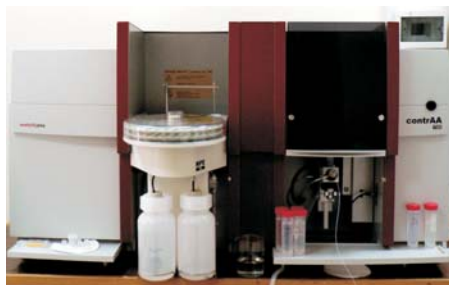
Атомно-абсорбционный спектрометр «ContrAA 700» и типичный объемный 3D-спектр поглощения атомов металлов в растворе
