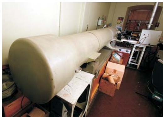
Атомно-эмиссионный спектрометр «ДФС-13» с ФЭК «МОПС» и рабочее окно программы с атомно-эмиссионным спектром пробы сульфидной руды
