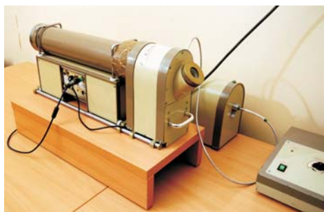
Импульсный катодолуминесцентный анализатор «Клавир» и спектр рентгенолуминесценции циркона с разложением на компоненты, связанные с ионами РЗЭ и собственными А-В-С-дефектами
